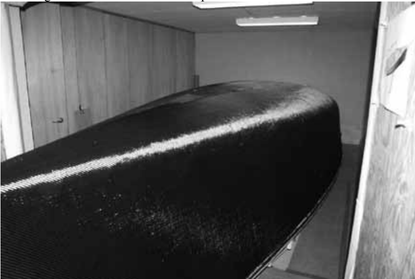
Skroget med færdigt kulfiberoplæg uden epoxy
